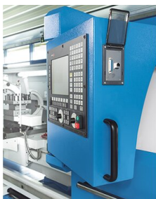
Złącze do transmisji danych, wychyłna jednostka sterująco-obslugowa
